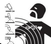
جريان الکتریک از درون هر جسم رسانایی که عبور نماید میدان الکتریکی و مغناطیسی (EMF) ایجاد می کند. جوشکاری و جريان جوشکاری اين ميدان را به دور کابلها و دستگاه ایجاد می نمایند، میدان مغناطیسی بر عملکرد ضربان سازهای قلب تاثیر می گذارد. استفاده کنندگان از تجهیزات الکترونیک حیاتی (نوسان ساز قلب) می بایست قبل از شروع به جوشکاری، برشکاری، گوجینگ و جوش نقطه ای، با پزشک خود مشورت نمایند
