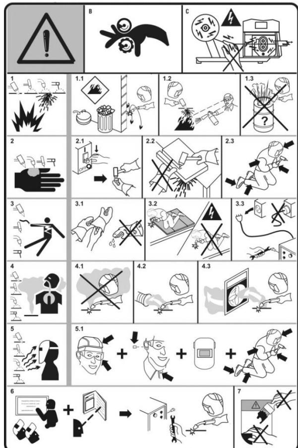
B- حلقه ها و چرخدنده ها می توانند به انگشتان آسیب برسانند. در دستگاه (MIG. MAG)
